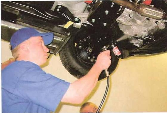
Verwechslung auch bei ausgestanzter Motor- und Fahrgestellnummer unmöglich: Die „Mighty Dots“ werden an allen unmöglichen Stellen des Autos aufgesprüht
